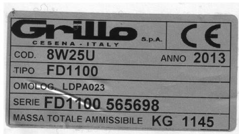
El cortacésped FD 1100 está equipado de una placa con el número de bastidor de la máquina, posicionada sobre un lado del chasis.
