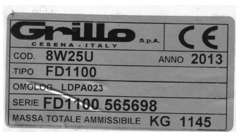
La tondeuse Grillo FD 1100 est munie d'une plaquette d'identification placée sur le côté du châssis avec le numéro de série de la machine.
