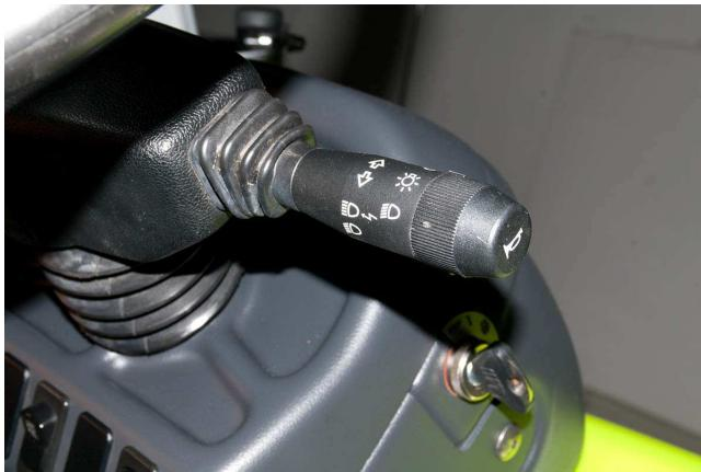
Fig. 3- Comutatore luci ed avvisatore acustico
