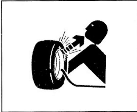
La separazione fra pneumatico e cerchione, causata dall'esplosione del pneumatico, può provocare serie ferite o addirittura la morte.
