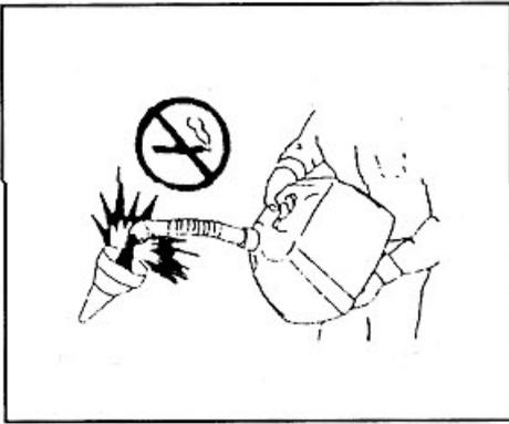
Maneggiare il carburante con cura, è altamente infiammabile; non fate rifornimento mentre fumate, o vicino a fiamme o scintille, o quando il motore è acceso.
