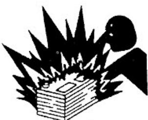
Per prevenire l'esplosione della batteria, tenete scintille, fiammiferi accesi e fiamme, lontani dalla stessa. Il gas della batteria può esplodere.
