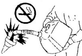
Maneggiare il carburante con cura, è altamente infiammabile; non fate rifornimento mentre fumate, o vicino a fiamme o scintille, o quando il motore è acceso.
