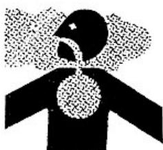
I gas di scarico possono causare malanni o morte. Se è necessario mettere in moto un motore in uno spazio chiuso, usare una prolunga tubo di scarico per far uscire il fumo. Lavorare in una zona ben ventilata.
