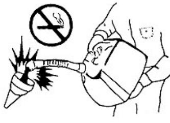
Maneggiare il carburante con cura, è altamente infiammabile; non fate rifornimento mentre fumate, o vicino a fiamme o scintille, o quando il motore è acceso.
