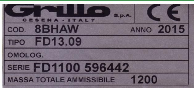
La tondeuse Grillo FD13.09 est munie d'une plaquette d'identification placée sur le côté du châssis avec le numéro de série de la machine.
