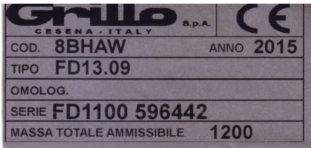
El cortacésped FD 13.09 está equipado de una placa con el número de bastidor de la máquina, posicionada sobre un lado del chasis.
